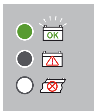
Fig. 4 esempio di etichetta posta sul coperchio della batteria con indicazioni di stato del " Check Control ".
